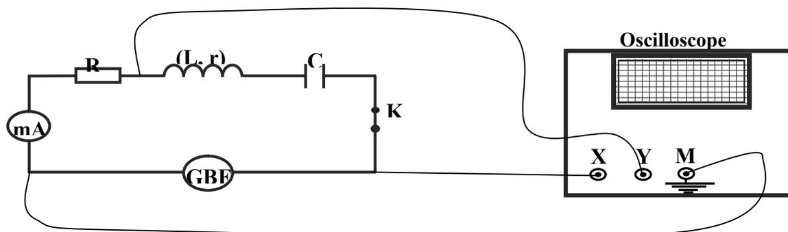
4-a  $\forall N$ , on a  $Z > R \Rightarrow Z I_m > R I_m \Rightarrow U_m > U_{Rm} \Rightarrow$  la courbe qui a l'amplitude la plus grande correspond à  $u(t) \Rightarrow (C_1)$  correspond à  $u(t)$  (même sensibilité verticale).
