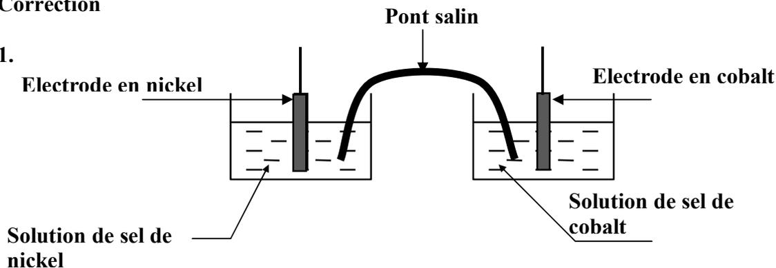
Symbole de la pile :  $\text{Ni} \mid \text{Ni}^{2+} \parallel \text{Co}^{2+} \mid \text{Co}$
