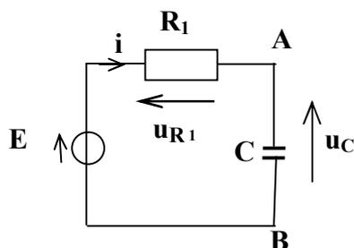
$$E - u_{R1} - u_C = 0 \quad \text{avec : } u_C = \frac{q}{C} ; u_{R1} = R_1 i ; i = \frac{dq}{dt} = C \frac{du_C}{dt} ;$$
